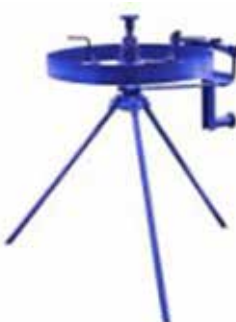
Držák drátu #400.500 Držák drátu slouží k uložení a odvíjení standardních svazků (cca. 25kg) nástřikových drátů. Držák je vybaven rovnacími kladkami, které zabezpečují narovnání drátu a jeho správné podávání s požadovaným předpětím do hořáku při nástřiku. Držák je v robustním provedení, skládající se z kovových částí.
